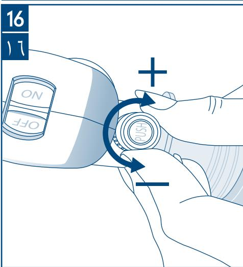
El regulador de succión regula el nivel de succión durante el proceso de extracción
