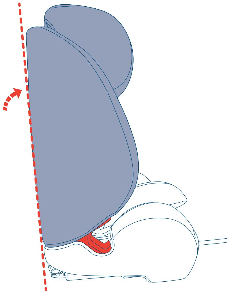
Reclining adjustment, ترتيب خواباتدن صندلی به پشت, تعديل الانحناء للوراء, Réglage de l'inclinaison, Anpassung der Neigung, Ρύθμιση κλίσης, Pengaturan posisi rebah, 기울기 조절, 倾斜调节, Regulacja pochylenia, Ajuste reclinável, Регулировка угла наклона, Ajuste de inclinación, การปรับมุมเออน, Yatırımanın ayarlanması
