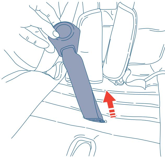
Removing the Top Tether, باز کردن کمند بالا، إزالة الشريط العلوي، Retirer le système de fixation supérieure, Entfernen des oberen Haltegurts, Αφαίρεση του άνω σημείου πρόσδεσης, Melepas tali penambat, 상단 테더 풀기, 拆卸顶部系绳, Zdejmowanie górnego paska mocującego, Como tirar o tirante superior, Снятие якорного ремня Top tether, Cómo sacar anclaje superior, การปลดสายยึดส่วนบน, Sabitleme kayışının çıkartılması
